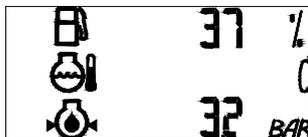
Pas d'indication en face du pictogramme « température de liquide de refroidissement » signifie que le transmetteur est débranché.
