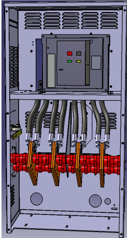
Lorsqu'un disjoncteur de calibre compris entre 2000A et 3600A sera commandé avec le groupe, l'utilisateur se raccordera sur des barres de connexion déportées. Ceci permet de fixer facilement l'ensemble des câbles de puissance requis pour l'application. Par ailleurs, les efforts mécaniques sur les disjoncteurs sont limités.
